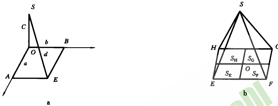
图 E2 辐射源对屏蔽墙所张立体角示意图
